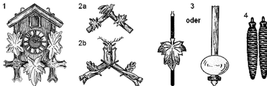
Bei Schnitzereiaufsätzen mit Hirschkopf zuerst den Hirschkopf mittels der beigefügten Schraube befestigen, dann den gesamten Aufsatz an der Uhr befestigen. Geweihe aufstecken. Geweihspitzen schauen dabei nach innen.
